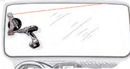
Akušroubovák nechte pomalu běžet doprava, přičemž otáčky přizpůsobujte zatížení. Při této operaci přidržujte v kabинě chránič mezi vyřezávací šňůrou a přístrojovou deskou, resp. obložením sloupku a stropním panelem tak, aby nemohlo dojít k poškození interiéru. Ve vyřezávání pokračujte jen do chvíle, kdy vyřezávací šnůra dosáhne pravého spodního rohu skla.
