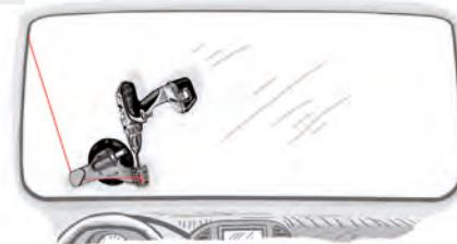
Le coin droit supérieur une fois atteint, positionner l'outil sur le coin supérieur gauche (fig. 5) puis sur le coin inférieur gauche (fig. 6) pour terminer l'opération.
