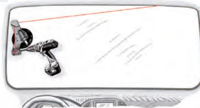
Włączyć wkrętak akumulatorowy z kierunkiem obrotów w prawo i niską prędkością obrotową, dostosowując prędkość obrotową w zależności od obciążenia. Podczas wycinania trzymać osłonę wewnętrz między struną do wycinania szyb a deską rozdzielczą lub słupkiem i podsufitką tak, aby uniknąć uszkodzeń wewnętrz pojazdu. Kontynuować proces wycinania do momentu, aż struna do wycinania dotrze do prawego dolnego rogu.
