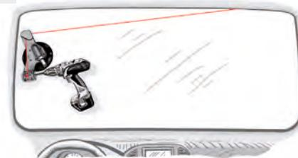
Faites tourner la visseuse sans fil lentement en mode vissage en modifiant la vitesse de rotation selon le besoin. Lors de cette opération, maintenir la protection de découpe intérieure entre la corde de découpe et le tableau de bord ou les barres et le ciel de toit afin que l'intérieur du véhicule ne puisse pas être endommagé. Poursuivre la découpe jusqu'à ce que la corde de découpe ait atteint le coin inférieur droit .
