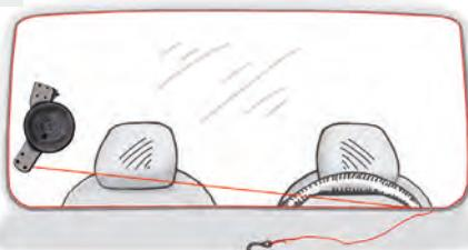
**ACHTUNG:** Achten Sie darauf, dass beim Austrennvorgang die Scheibenaustrennschnur keine Aggregate, Leitungen, Schläuche und Verkleidungen beschädigen kann und sichern Sie die Scheibe gegen herunterrutschen!
