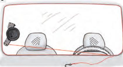
Wbić uchwyty do struny w lewym dolnym rogu szyby od wewnętrz do zewnętrz. (Rys. 1)
