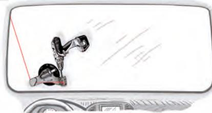
Kada dosegnete gornji desni kut ponovno promjenite položaj tako da uređaj dođe u gornji lijevi kut (slika 5), zatim u donji lijevi kut (slika 6) te do kraja dovršite postupak izrezivanja.
