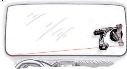
**UWAGA! Uważać, aby podczas wycinania szyby struna nie uszkodziła żadnego agregatu, przewodu, węza ani wykładziny, i zabezpieczyć szybę przed obsunięciem!**
