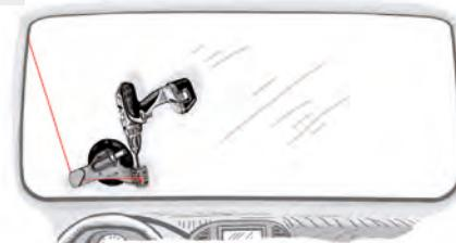
Bei erreichen der oberen rechten Ecke erneut Positionswechsel zur oberen linken Ecke (Abb. 5) danach Positionswechsel zur unteren linken Ecke (Abb. 6) und beenden Sie den Austrennvorgang komplett.
