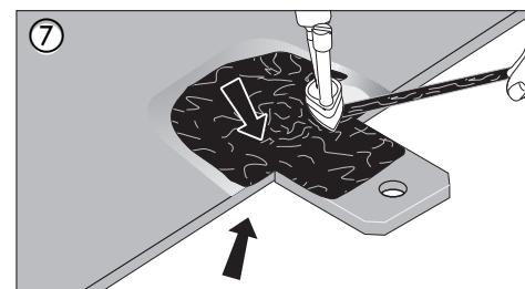
⑦ Mit der Kunststoff-Reparaturdüse den Multi-Thermoflexx Schweißdraht sorgfältig auftragen. Draht und Untergrund müssen gleichmäßig erhitzt werden und sich vollständig mit dem Untergrund verbinden. Material an den Rändern langsam glatt-streichen.
