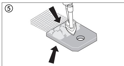
⑤ Mit der Kunststoff-Reparaturdüse das Edelstahl-Drahtgewebe auf der Vorderseite der Lasche in den Kunststoff einschmelzen. Das Gewebe vollflächig erwärmen und mit gleichmäßigem Druck verschmelzen.
