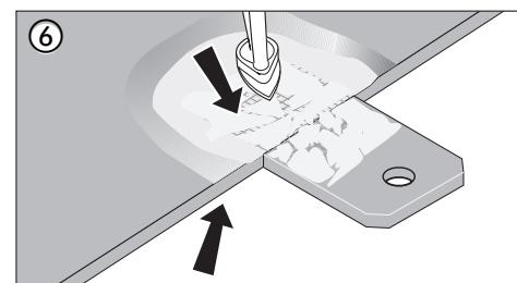
⑥ Die Lasche an die vorgesehene Stelle setzen und das Gewebe mit der KFZ-Reparaturdüse in den Kunststoff des Stoßfängers einschmelzen.
