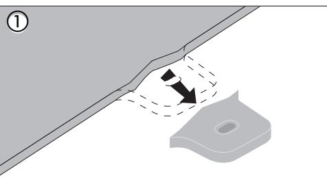
① Reparatur einer abgerissenen Befestigungs-lasche eines Stoßfängers.
