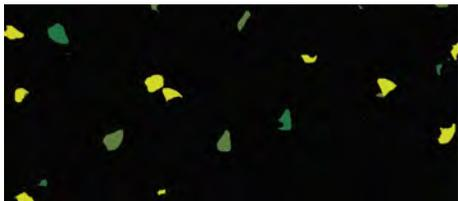
Die geschützte Kennzeichnung mit grünen und gelben Farbpartikeln weist die **Regupol® Antirutschmatten** als Originale aus. Verwechslungen mit Prüfberichten zu Antirutschmatten anderer Hersteller oder gar bewusstes Vertauschen sind damit ausgeschlossen. Denn nur original **Regupol® Antirutschmatten** besitzen diese Farbkennzeichnung.
